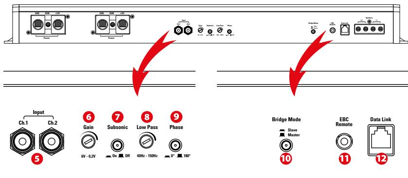
**5** Entradas RCA - Use estes conectores com fontes que tenham saídas de linha RCA. O nível mínimo de saída deve ser 200mV. O uso de cabos RCA de alta qualidade é recomendado para diminuir a possibilidade de ruído radiado poder entrar no sistema.
